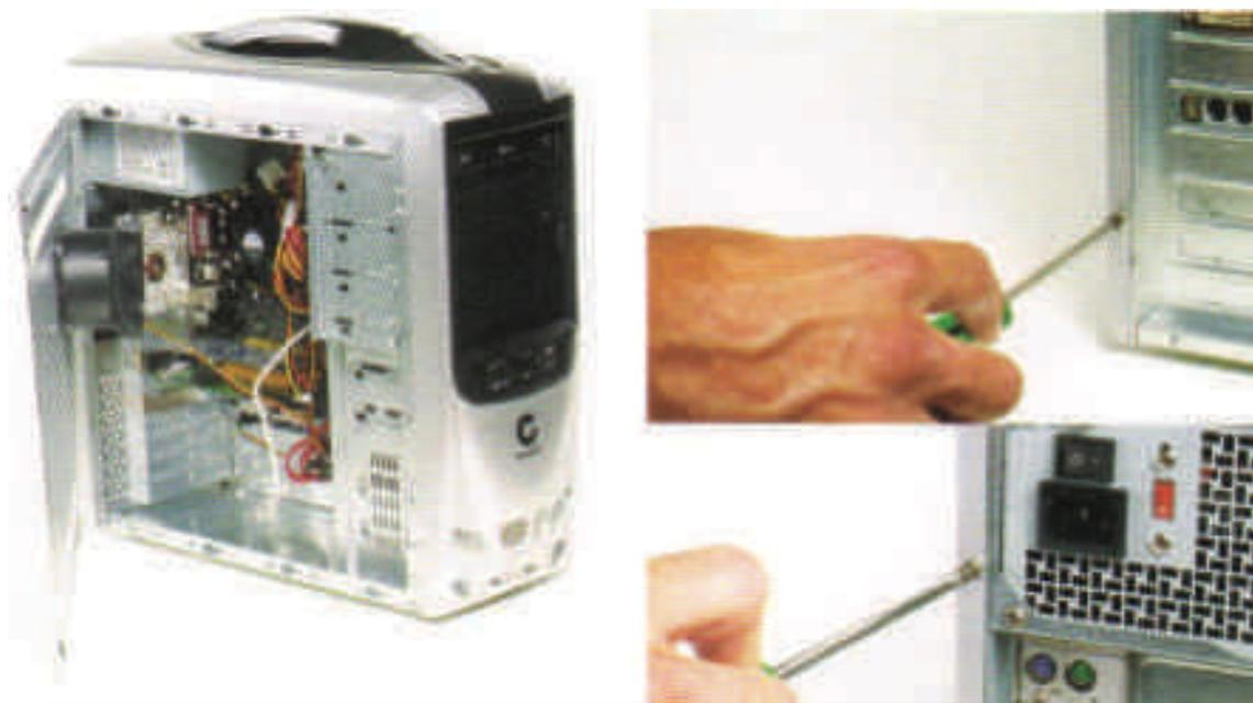
1. Após toda a instalação ou manutenção das componentes, prepare-se para fechar a caixa. Certifique-se de que todos os cabos estão ligados corretamente e organizados adequadamente. Coloque a tampa lateral, encaixando-a, conforme mostra a imagem.
