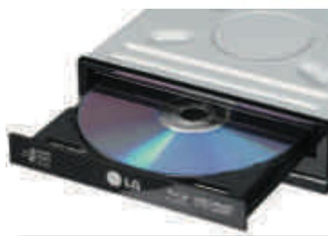
A velocidade de leitura e de gravação, no caso de um gravador de CD e ou DVD, são diferentes. Sendo a velocidade de gravação mais baixa. Há uma informação importantíssima que deve saber-se sobre unidades de DVD-ROM. Se não se usar uma placa descodificadora MPEG-2, a descodificação do filme gravado em DVD será efetuada pelo processador da máquina.
