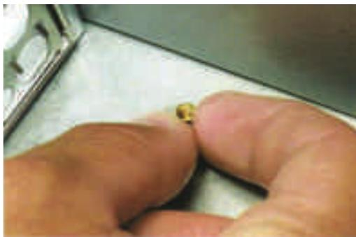
8. Vamos instalar as componentes dentro da caixa, a começar pela motherboard. Insira a rosca de base obedecendo ao indicado na motherboard. Muita atenção para não apertar em orifícios que não são compatíveis com o modelo da motherboard. O encaixe inadequado pode ocasionar danos à placa.
