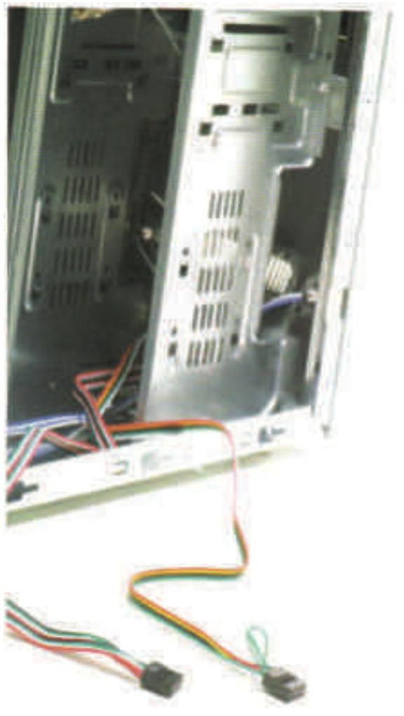
1. Separar os cabos que saem de dentro da caixa, identificando o cabo USB e o de Áudio. Neste caso, o cabo áudio pode ser identificado pelo fio (verde) próximo do encaixe.
