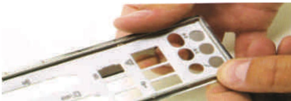
6. Retire, com cuidado, a moldura que envolve a chapa, conforme mostra a imagem.
