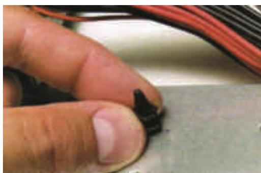
9. De seguida, vamos fixar a base de suporte com travão. Esta pode ser substituída por algumas bases de rosca, porém nunca deverá ser usada em todas as furações da motherboard para não comprometer a sua fixação.
