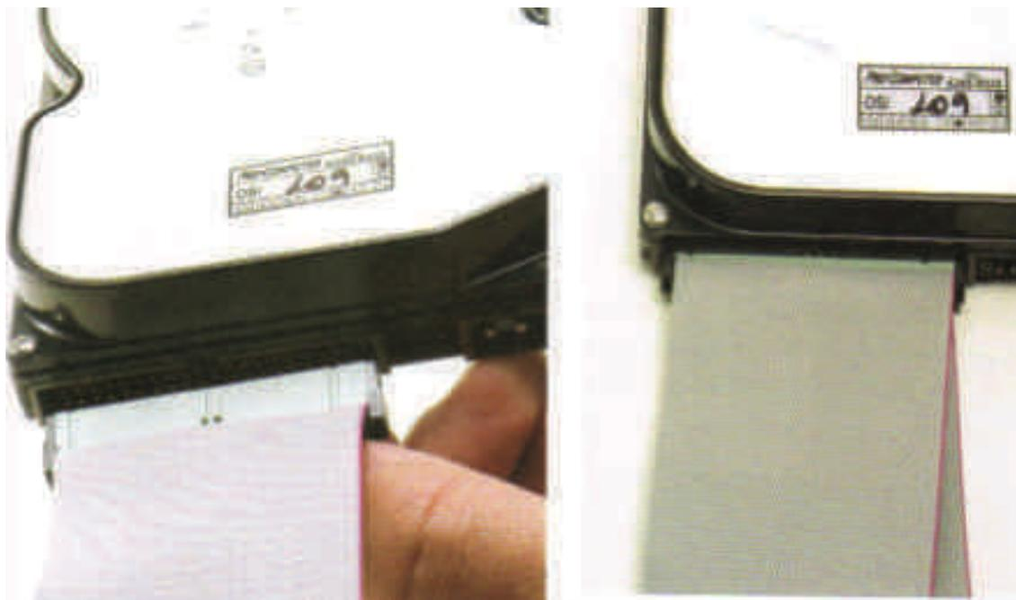
Esta é a visão em detalhe da conexão do cabo IDE no HD, realizada no passo 5.
